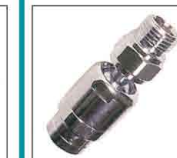
●AAO4 セカンダリースイベル アダプター No. 7721 6000 900045 ¥6,600 ●オス9/16-メス9/16 ●通常ホースと組み合わせ、スイベル機能を高めるアダプターです。(セカンダリースイベル)
