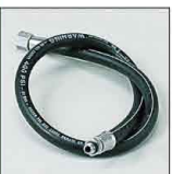
●レギュ用 中圧ホース(LP) No. 7710 7000 600024-5-550583 ¥7,700 ●レギュレーター用の中圧ホース。●レンチ1つで簡単に取付けができます。 ●オス3/8、メス9/16 ●ホースの長さ68cm。
