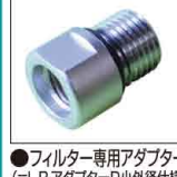
●フィルター専用アダプター (=LPアダプター-D)小径仕様 No. 7736 3000 900072 ¥3,300 ●材質:真鍮合金 ●全長:21.5mm ●外径:φ18.0mm ●ネジ径:3/8インチネジ24UNF ●LP用、Oリング付き
