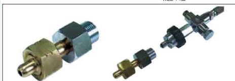
●CA-W22-He 変換アダプター No. C522 0000012 ●W22-14山をヘリウム用 W21-14山 左ネジへ変換
