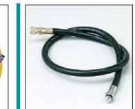
●高圧ホース No. 7714 6800 600804-5-550473 ¥7,480 ●サイズ/長さ約80cm ●ゲージ(洗圧計)に対応するホース ●ネジ径:7/16" UNF ●最大使用圧力:350kg/cm 2 ●最小曲半径:70mm(R)以上(加圧時) ●対応:SM-36モーター、SM-26モーター
