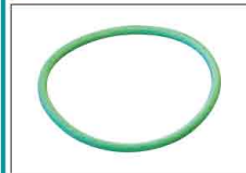
●Oリング No. C630 000053 ●バウア→コンプレッサー用Oリング ●安全弁の下側にあるカートリッジフィルターハウジングのOリングです ●カートリッジ交換時には、チェックして下さい ●予備に数個常備しましょう
