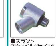
●スラント スイベルジョイント No. 7738 8000 850086 ¥8,800 ●材質:真鍮合金 ●外寸:31.9x28.0mm ●ネジ径:3/8インチネジ24UNF ●LP用、Oリング付き
