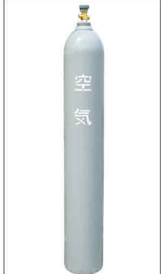
●親ボンベ 50ℓ 19.6MPa No. C524 0000089 ●高さ:154.5cm●直径:23.2cmφ ●重量:58kg ●親ボンベ 68ℓ 29.6MPa No. C525 0000033
