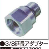
●3/8延長アダプター No. 7734 3000 900072 ¥3,300 ●材質:真鍮合金 ●全長:19.5mm ●延長高:11.5mm ●外径:φ15.5mm ●ネジ径:3/8インチネジ24UNF ●LP用、Oリング付き
